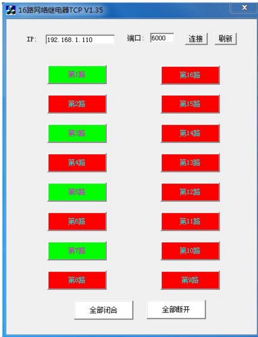
上图为继电器控制板与软件连接后图示。软件可以控制继电器动作，并显示继电器状态，软件图标红色代表断开，绿色代表闭合。
