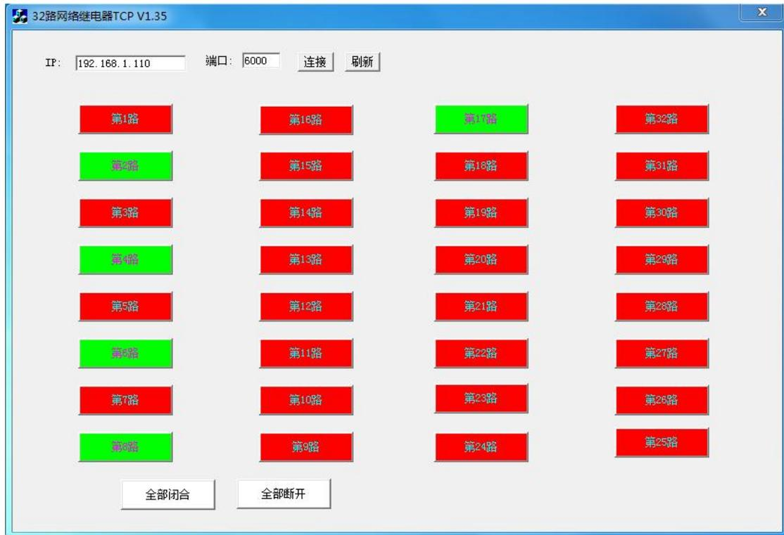
输入输出产品，1-16路代表1-16路继电器输出，17-32路代表1-16路输入。上图为继电器控制板与软件连接成功后图示，软件可以控制继电器动作，也可以显示输入和输出的状态，软件图标红色代表断开，绿色代表闭合。
